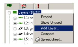
ドリル穴図を作成する、レイヤーを追加します。 Layers を選択、右クリックメニューから Add Layer…を選択 します。
