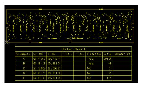
カーソルヘドリル穴図がセットされ ます、クリックして配置します。
