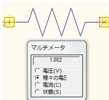
抵抗の左側のピンをクリック、次に右側のピンをクリックし続けると電圧が表示されます。
