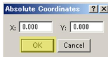
座標を入力して移動する場合は、移動先のレイヤーを選択後、「Enter」キーを押します。移動座標を指定します。
