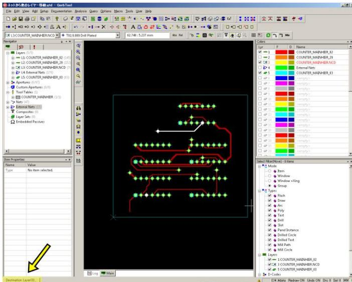
ステータスバーに表示された「Destination Layer」をクリックします。
