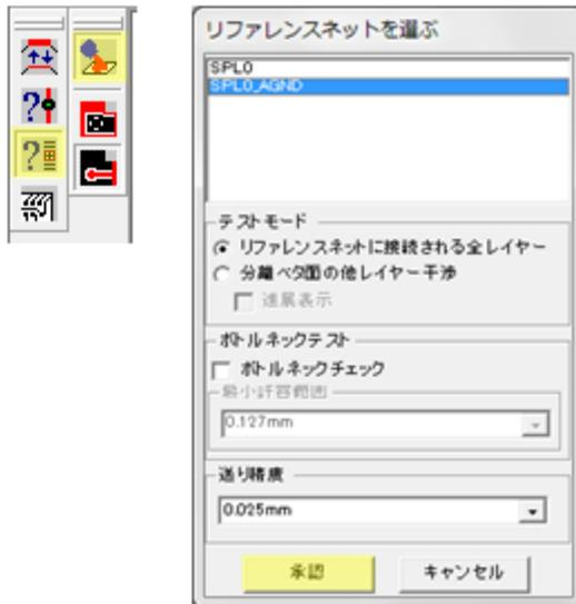
作成したベタがエアギャップまたはサーマルパッドにより分離されていないか確認します。
