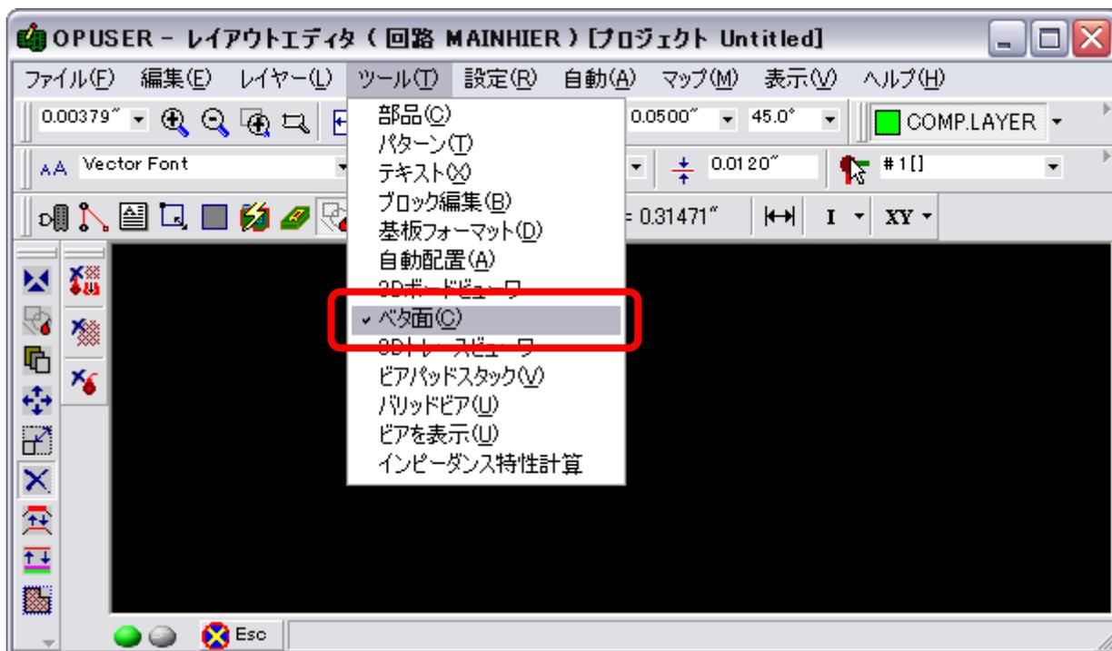
図形を配置するパターン面を選択します。
