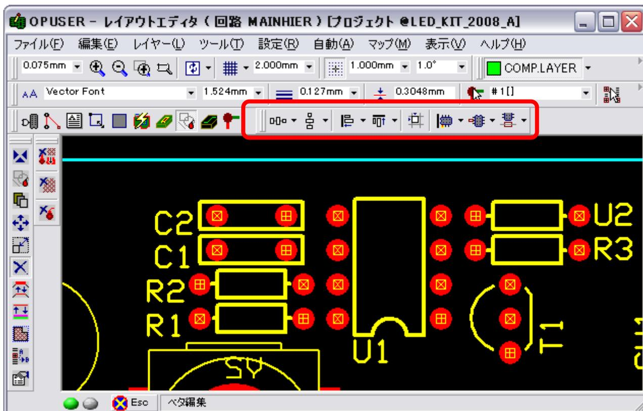
「Ctrl」キーを押しながら、方向を変えたい部品のピンをクリックして選択。(複数可)
