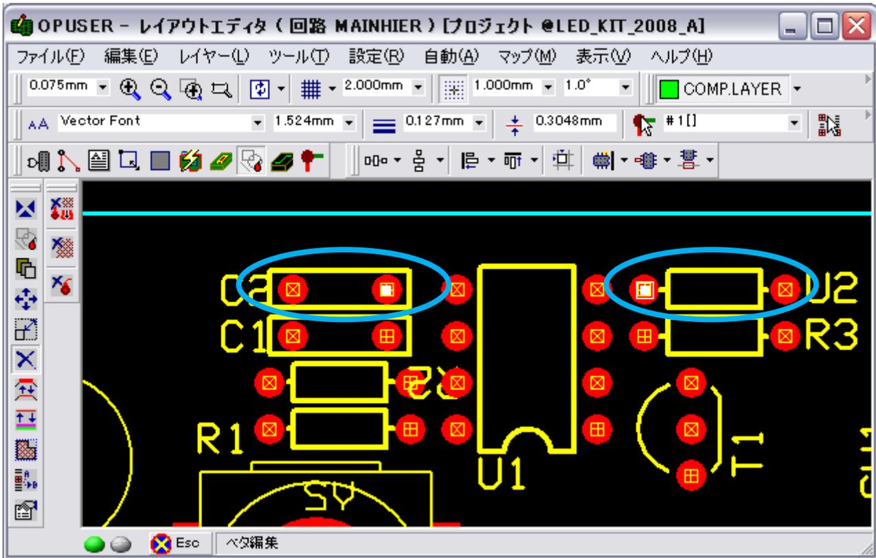
部品のピンに白い四角が表示されている状態で、『整列／配置』ツールから方向を選択。
