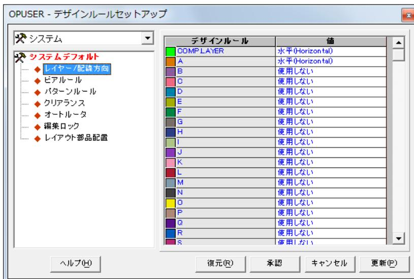
レイヤー／配線方向を選択し、使用する内層のレイヤーの値を「水平」もしくは「垂直」を選択します。
