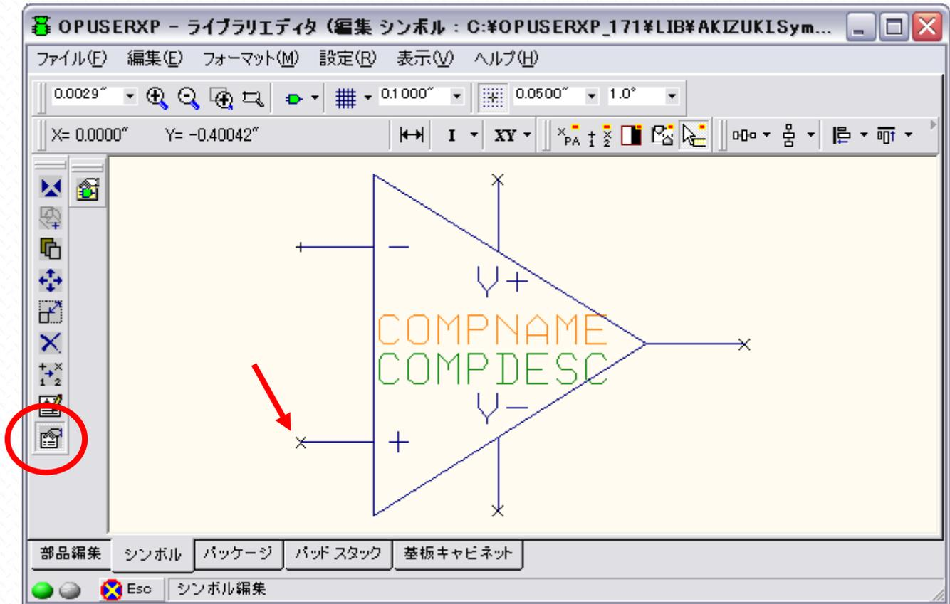
表示されるピンのプロパティにて、MMエン트리（ミックスモード）を選択します。“ESC”ボタンで作業を終了するか、続けて次のピンをクリックし、全てのピンにエントリを割り当てます。
