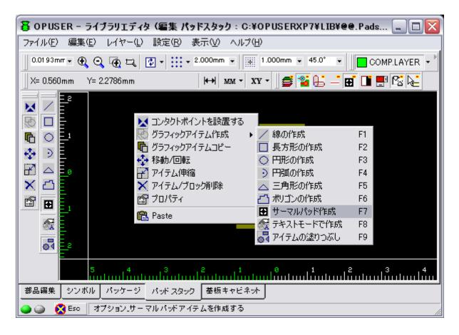
目的の形状に図形を配置してサーマルパッドとします。
