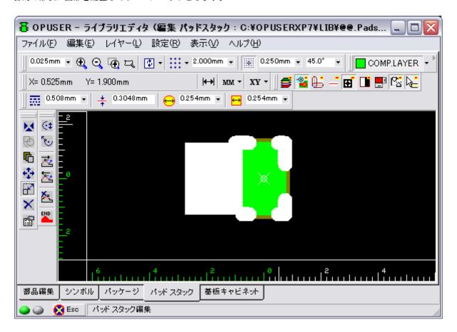
SMD チップのパッドとして使用すると、図のような銅箔となります。パッドを配置する際の方向に注意して下さい。
