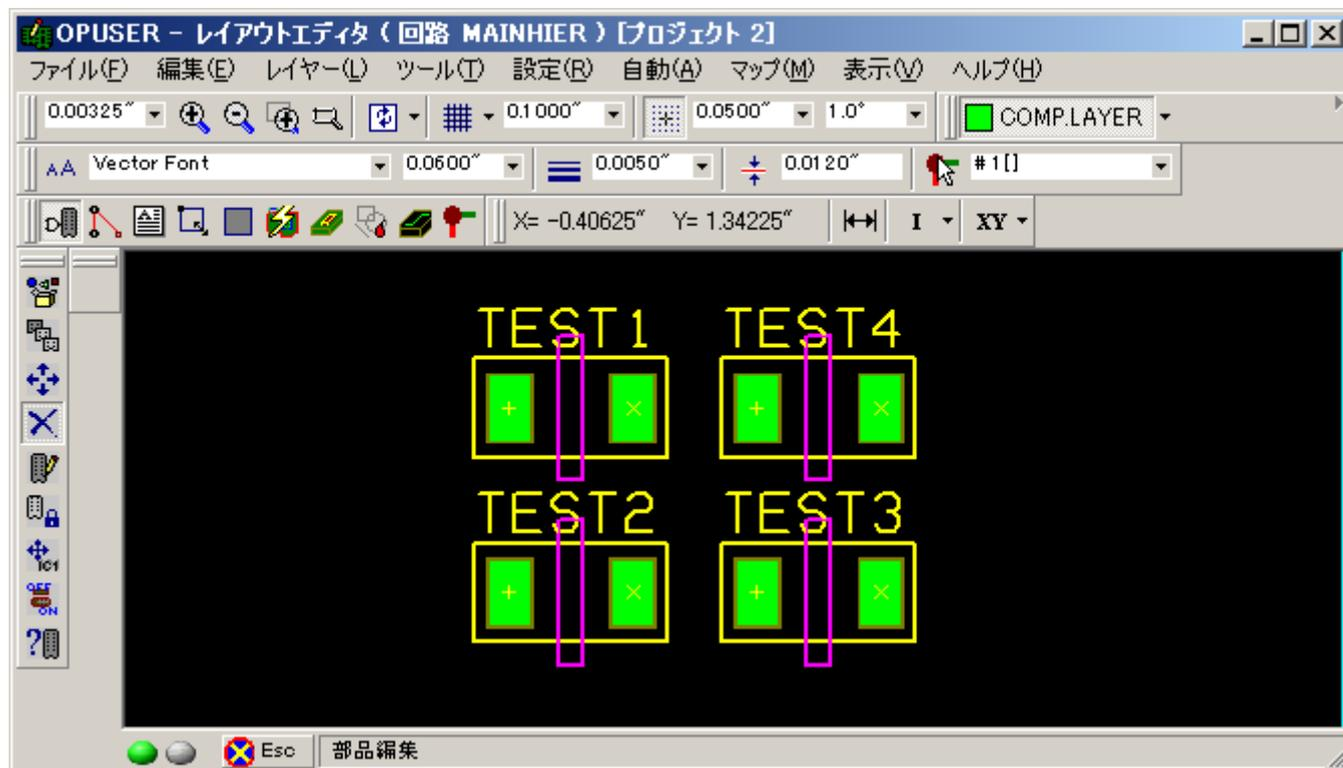
図形を作成したレイヤーをガーバー出力します。
