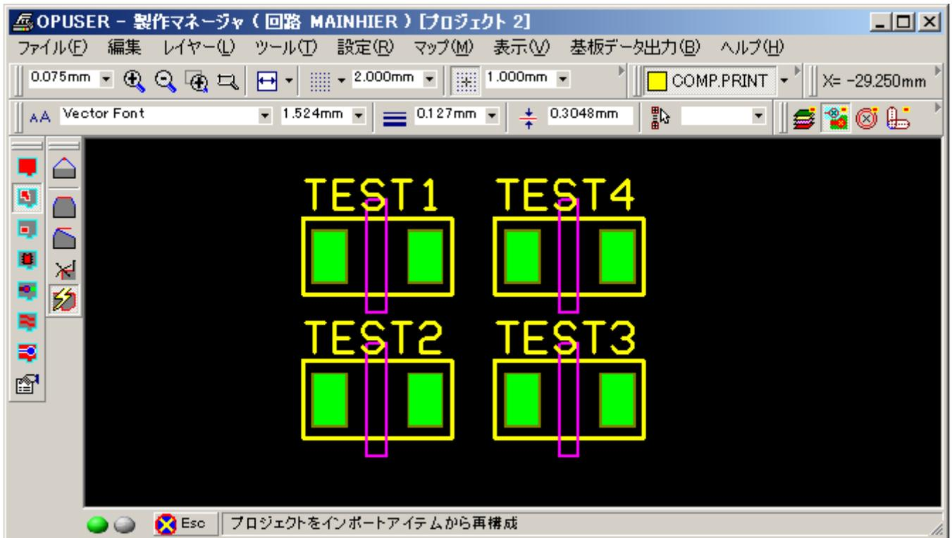
『カットアウト再構成/自動再構成』を選択、読み込んだ長穴となるカットラインを選択します。
