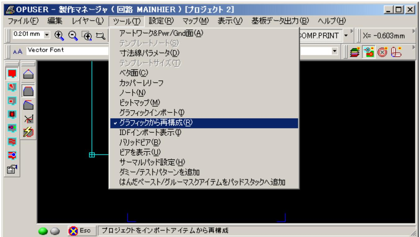
既存の部品に重なった状態で表示されます。前回インポートしたデータがズレて表示されている場合、位置ずれが起こります。
