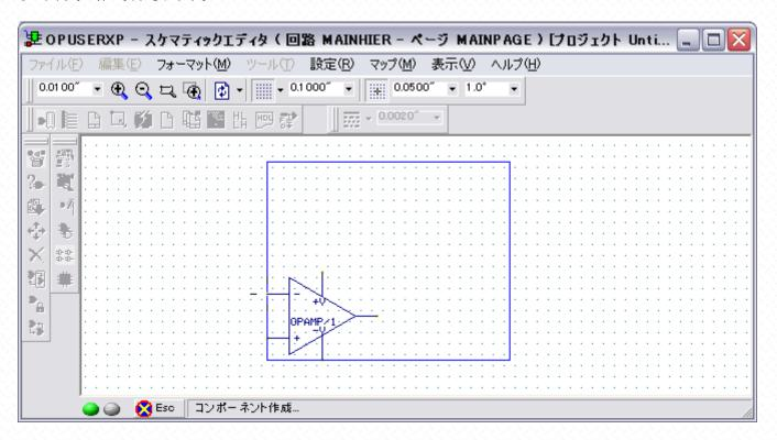
クリックして配置を行うと、回路記号がパッケージングされた状態で配置されます。
