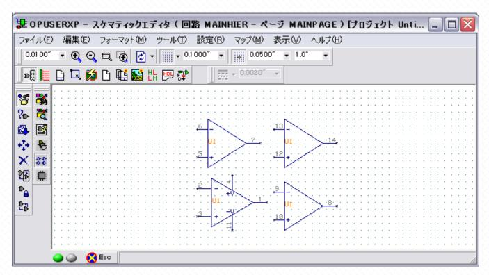
配置後に部品のピンナンバーを変更したい時には、"ゲートの交換"を使用して下さい。
