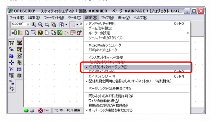
ライブラリから部品を引き出すと、回路記号がカーソルにセットされますが、インスタントパッケージングを有効にしていると、同時に枠が表示されます。
