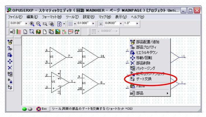
ゲートの交換を使用すると、パッケージングされた記号の入れ替えが可能です。また同一部品であれば、U1/U2間であってもゲートの交換ができます。
