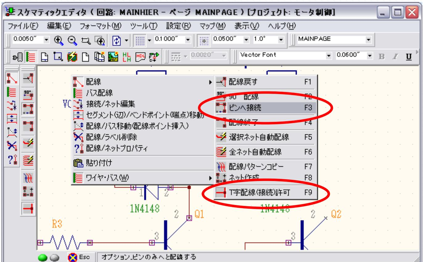
部品接続ピンの上でクリック、カーソルを少し動かすとピンの上に青い四角が表示されます。
