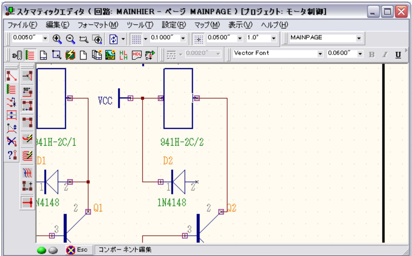
T字配線する際、そのまま“ピンに配線”機能が有効になっていると、配線への接続が出来ない為、配線を引き始めた後に、“90°配線”へと切り替えます。
